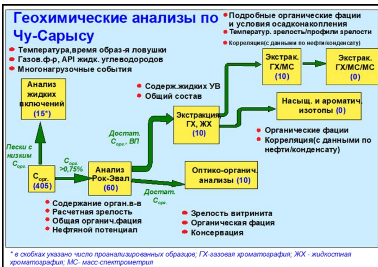
Рисунок 7.1 – Методика геохимических анализов методом Рок Эвал (Акчулаков У.А., 2004).
